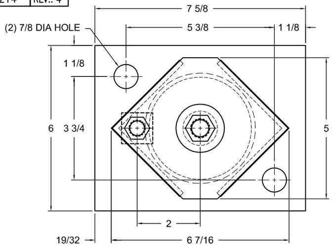
**TYPE AMSR-2D-SB SEISMICALLY RESTRAINED SPRING VIBRATION ISOLATORS WITH SHIPPING BLOCK**
